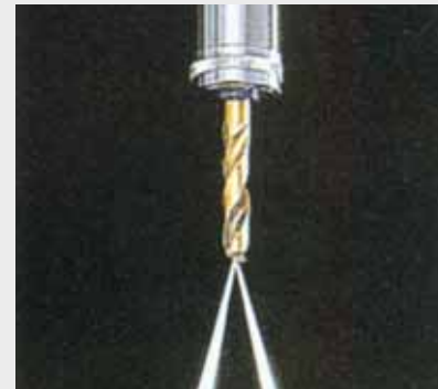
主軸貫穿冷卻裝置(不含刀具)
