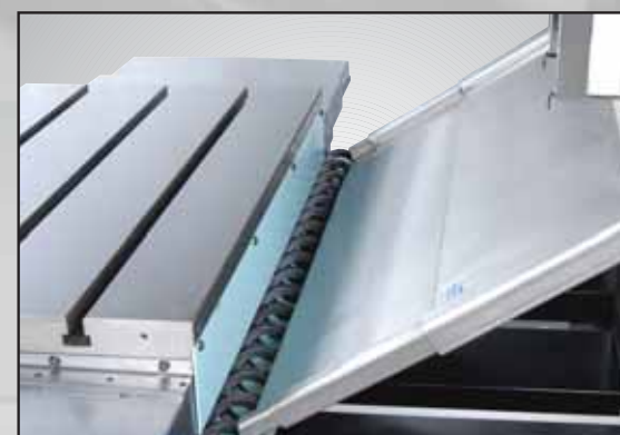
切屑螺桿 機械加工中，切屑經強力沖屑落至切屑螺桿，再輸送至切屑輸送機排出機外。有效清除切屑，避免切屑之熱影響結構精度並可隨時保持工作區域之清潔。
