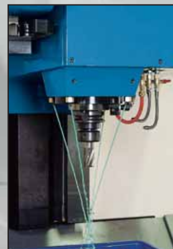
主軸環噴 環噴冷卻設計，可迅速排除刀具及工件之熱量，有效提昇加工精度。
