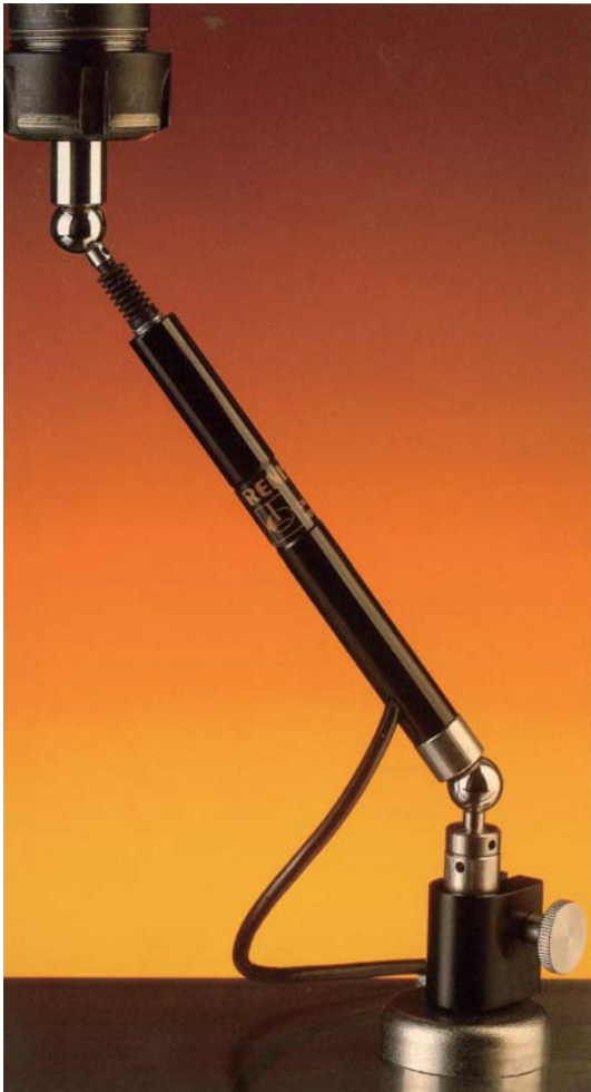
主軸動態運轉精度檢驗 採用最先進的主軸運轉測試儀器，精密檢驗主軸運轉精度及溫昇熱變形。
