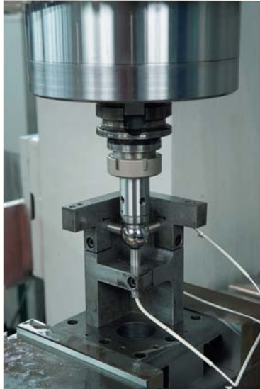
主軸動態運轉精度檢驗 採用最先進的主軸運轉測試儀器，精密檢驗主軸運轉精度及溫昇熱變形。
