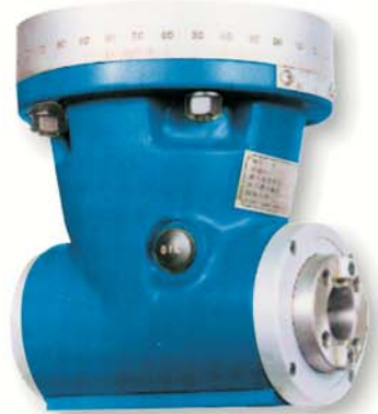
90 度銑頭 (選購附件) 90°銑頭可將立式加工轉換成臥式加工，可安裝NT#50刀柄用。
