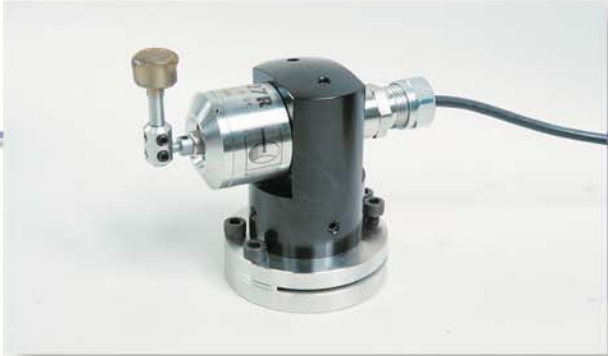
接觸式刀長量測 利用刀長量測裝置，以檢驗刀具磨耗情況，可隨時保持高精度加工的穩定性。
