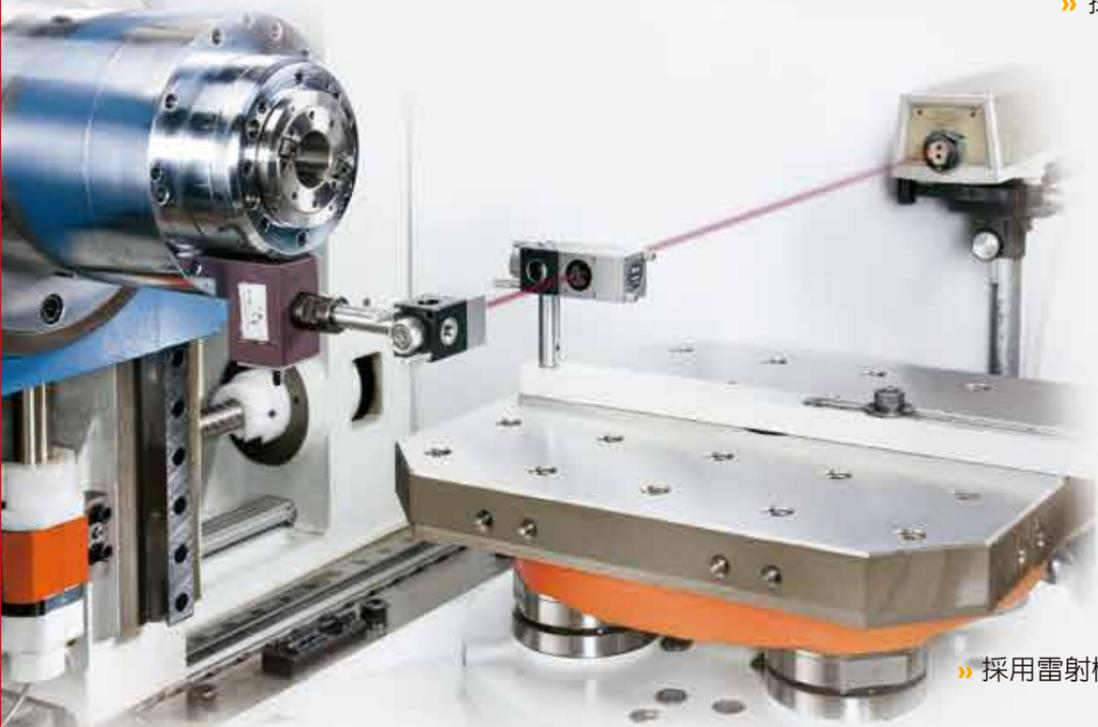
» 採用雷射檢驗線性位置精度。
