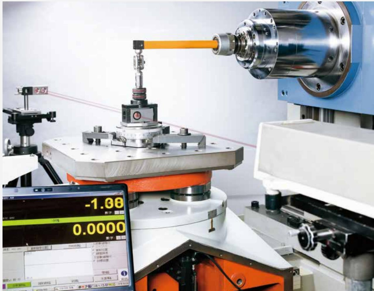
» 採用雷射檢驗分割精度。
