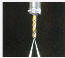
COOLANT THROUGH SPINDLE DEVICE
